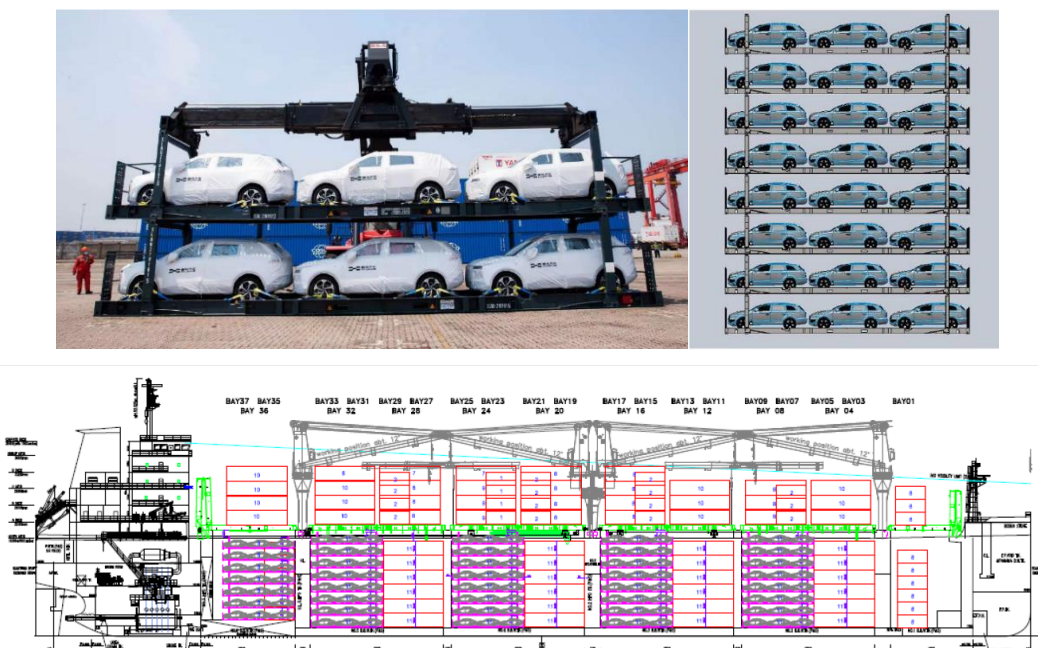
Ilustración 1: Apilamiento de Racks Plegables de Vehículos de 48 pies
